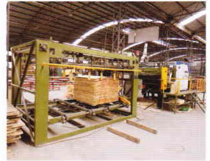
コアビルター Veneer Splicing machine
